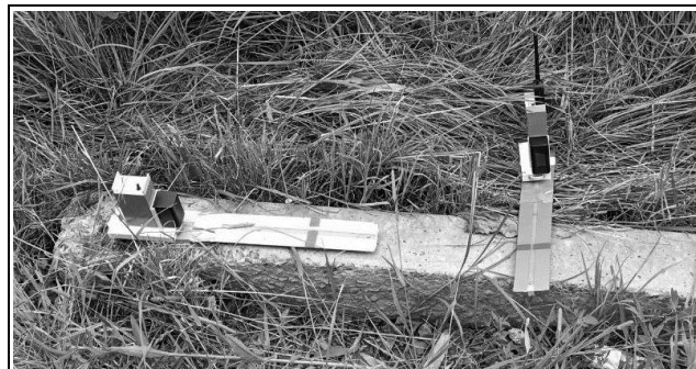
Рис. 8. Измерение длины железобетонного осветительного столба
